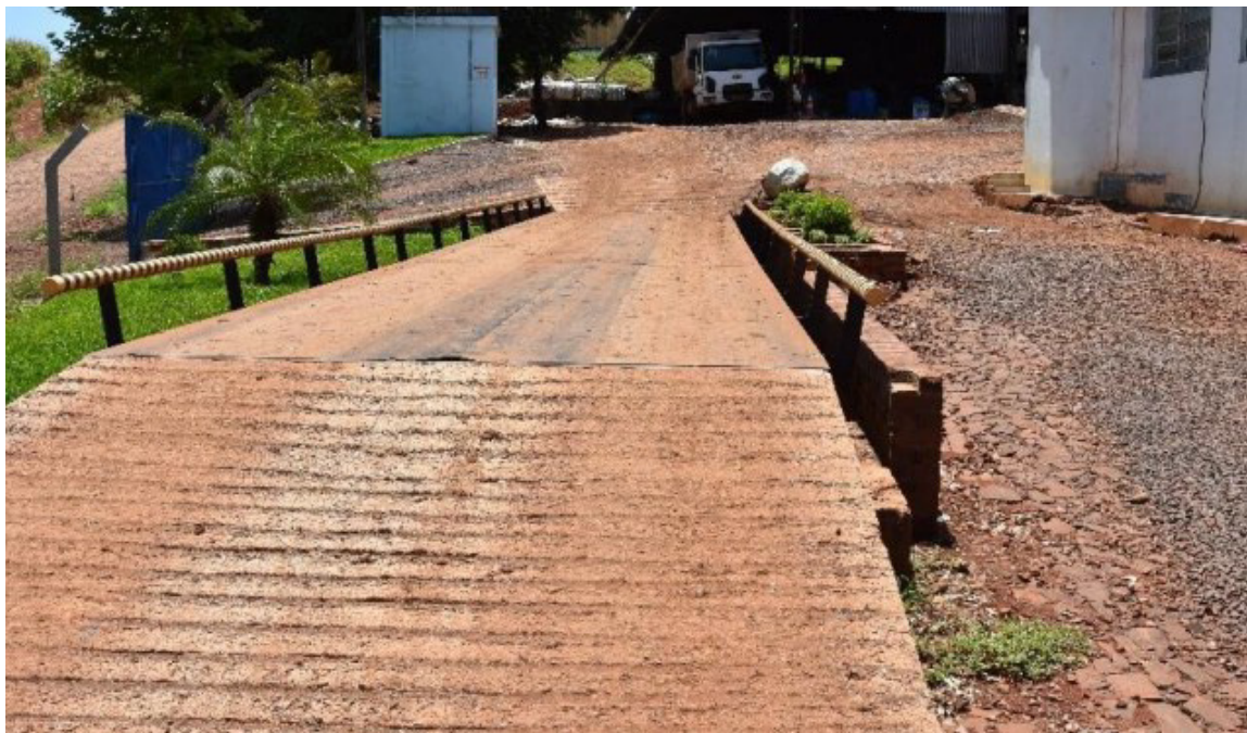
Figura 15 - Balança de pesagem dos caminhões.
